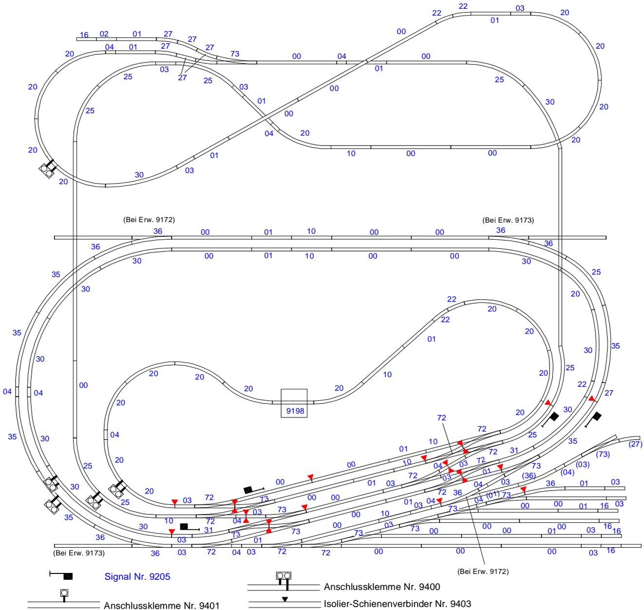
Die Weichen des Überholgleises/Abstellgleises können durch Entfernen der aussere Drahtbrücken in zweiseitig wirkende Stop-Weichen verwandelt werden. Dadurch können Loks nach Umstellen der Weichen stromlos abgestellt werden.
